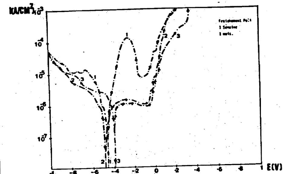
Fig 5 : Courbes de polarisation de l'acier 316 L + Cu
